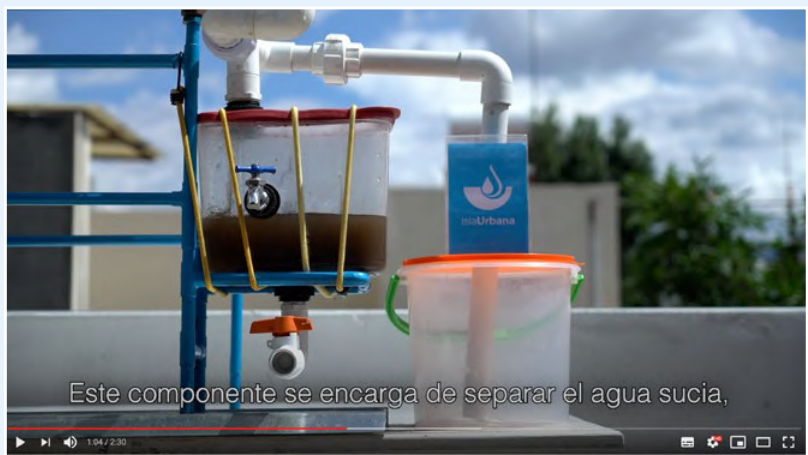
¿Qué es y cómo funciona el Tlaloque o separador de primeras lluvias? https://youtu.be/x6lsYsV3BEk
